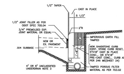
TYPICAL CURB CONSTRUCTION DETAIL
