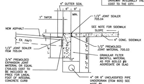
CAST-IN-PLACE CONCRETE CURB
