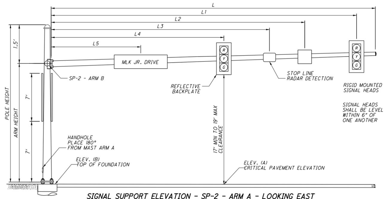
SIGNAL SUPPORT ELEVATION - SP-2 - ARM A - LOOKING EAST
